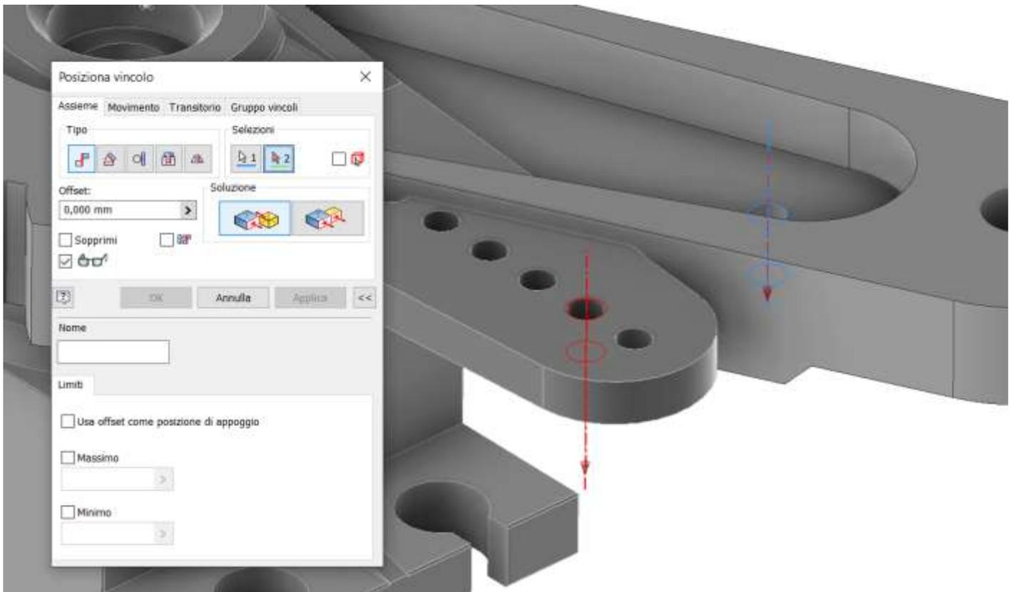
Vincoliamo la parte "frame motore" al motore utilizzando dei vincoli di coincidenza fra piani (per 3 volte).
