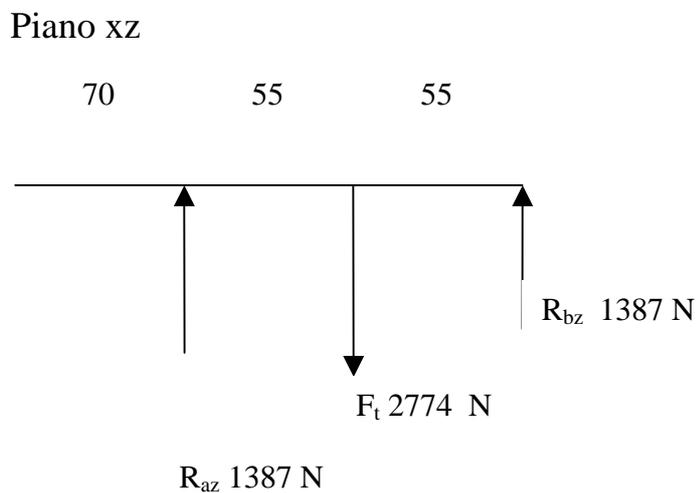
Questa situazione di carico la sezione più sollecitata risulta essere la sezione A con momento flettente pari a 86520 Nmm e momento torcente pari 118600 Nmm. Scelto come materiale dell'albero 39NiCrMo3, avente  $\sigma_{sn} = 735$  Mpa, con un coefficiente di sicurezza pari a 6, dimensionando l'albero a flessotorsione con il criterio di von Mises si ottiene un diametro  $d >$  di 21.6 mm. Si assume un diametro pari a 25 mm.
