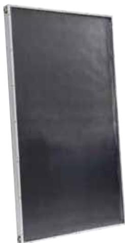
Collettore di nuova generazione **CR 110 e CR120 SELECTIVE** per la circolazione naturale e forzata. L'alto rendimento è garantito dalla piastra captante con trattamento selettivante. Il profilo è in acciaio zincato verniciato a polveri, con all'interno isolamento in schiuma poliuretanic. La copertura è in vetro temprato dello spessore di 3,2 mm con elevata resistenza contro la grandine e con finitura superficiale prismatica per una riflessione ridotta.
