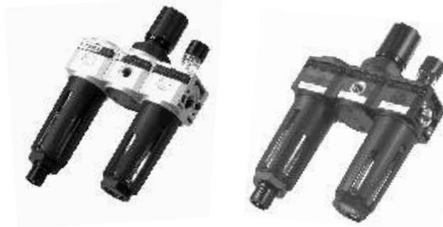
I gruppi di condizionamento costituiscono un'unità indispensabile affinché l'aria fornita ai componenti pneumatici sia secca e pulita, regolata come pressione e lubrificata, garanzia questa di una buona sicurezza di funzionamento. Sono costituiti (ved. fig. 11.11) da un filtro **1**, da un riduttore di pressione con manometro **2** e da un lubrificatore **3** interconnessi in un unico blocco.
