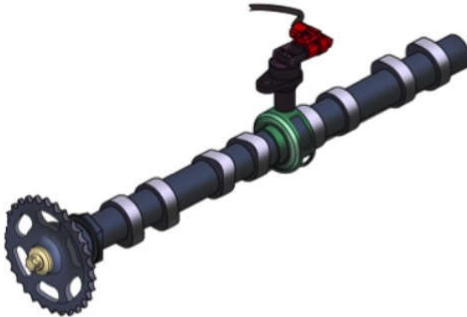
Il **sensore fase** legge le rotazioni dell'albero a cammes e trasmette il segnale alla centralina che identifica la posizione dello stesso permettendo così l'iniezione sequenziale.
