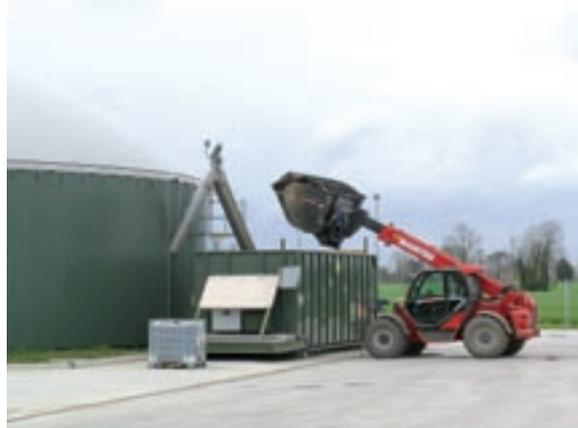
Tutti i reflui zootecnici prodotti nella stalla sono destinati ad alimentare l'impianto di DA. Questi consistono in liquame (allontanato 2 volte/d mediante raschiatori) e letame (asportato circa 1 volta/ 1 mese e ½ mediante pala meccanica che carica il materiale organico nei carri miscelatori/caricatori collegati ai digestori
