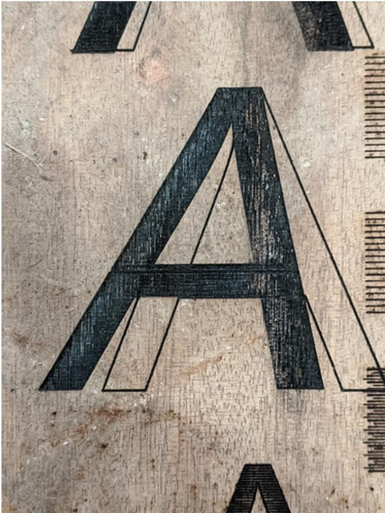
Se l'uscita è simile a questa, è probabile che la polarità del passo dell'impulso del motore sia impostata in modo errato. Sui controller Ruida, c'è un'impostazione chiamata "PWM Rising Edge Valid" che puoi modificare per ogni asse che dice al controller se il fronte di salita o di discesa di un impulso di passo è ciò che il driver del motore sta cercando. La modifica di questa opzione può correggere l'incisione distorta.
