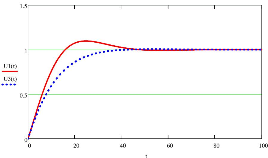
La retroazione annulla il disturbo e mantiene il sistema stabile
