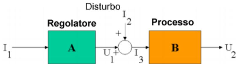
Effetto di un disturbo in ingresso al processo controllato
