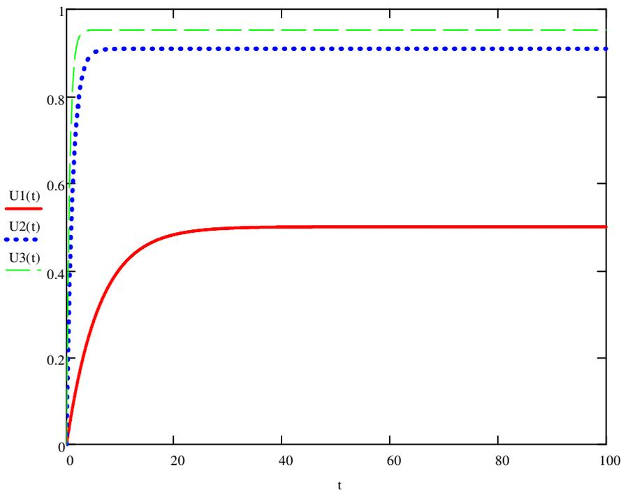
Riassumendo, utilizzando un controllore esclusivamente proporzionale (P) si produce una differenza (offset) tra il valore richiesto e quello effettivamente ottenuto. Tale differenza può essere ridotta aumentando il guadagno del controllore. Tuttavia, se il processo da controllare possiede coppie di poli c.c., l'aumento del coefficiente proporzionale è accompagnato da un corrispondente aumento delle oscillazioni generate a seguito di rapidi transitori.
