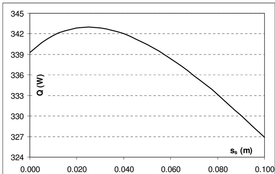
Si noti che la massima potenza scambiata non si ha in corrispondenza dell'ascissa  $s_s = 0$ . Il valore di  $s_s$  per il quale si verifica il massimo si può individuare differenziando rispetto a  $r_e$  la relazione per il calcolo della potenza termica scambiata ed uguagliando il risultato a zero.
