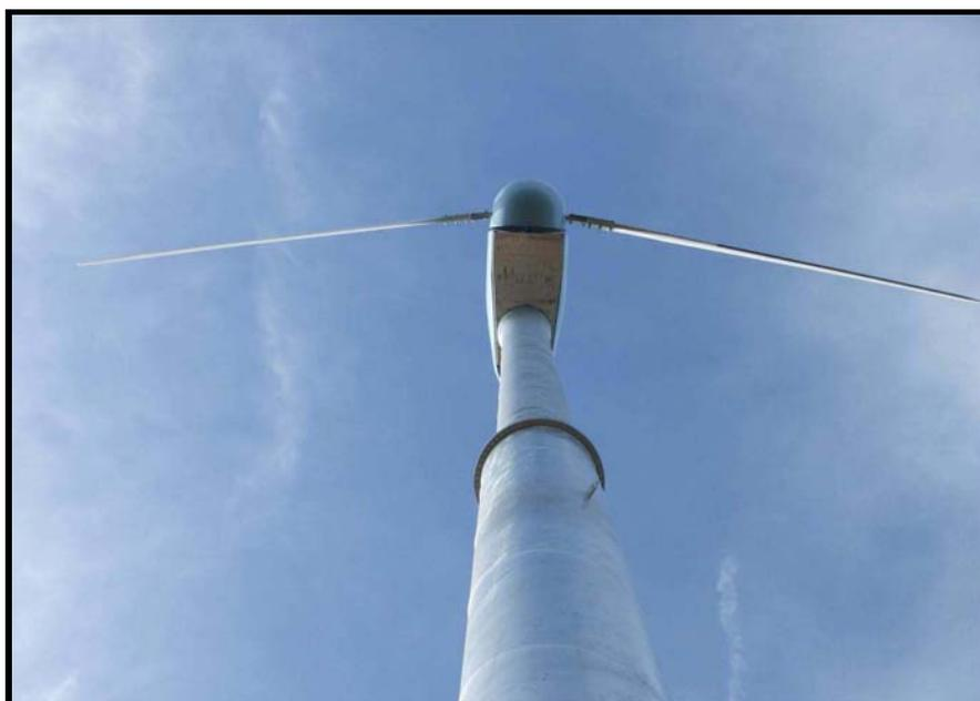
*Il montaggio su snodi rende le pale libere di oscillare nella direzione avanti-dietro per un piccolo angolo, eliminando tutti gli sforzi asimmetrici sull'asse del rotore in modo ancor più efficace di quanto ottenibile con rotori rigidi a tre pale.*
