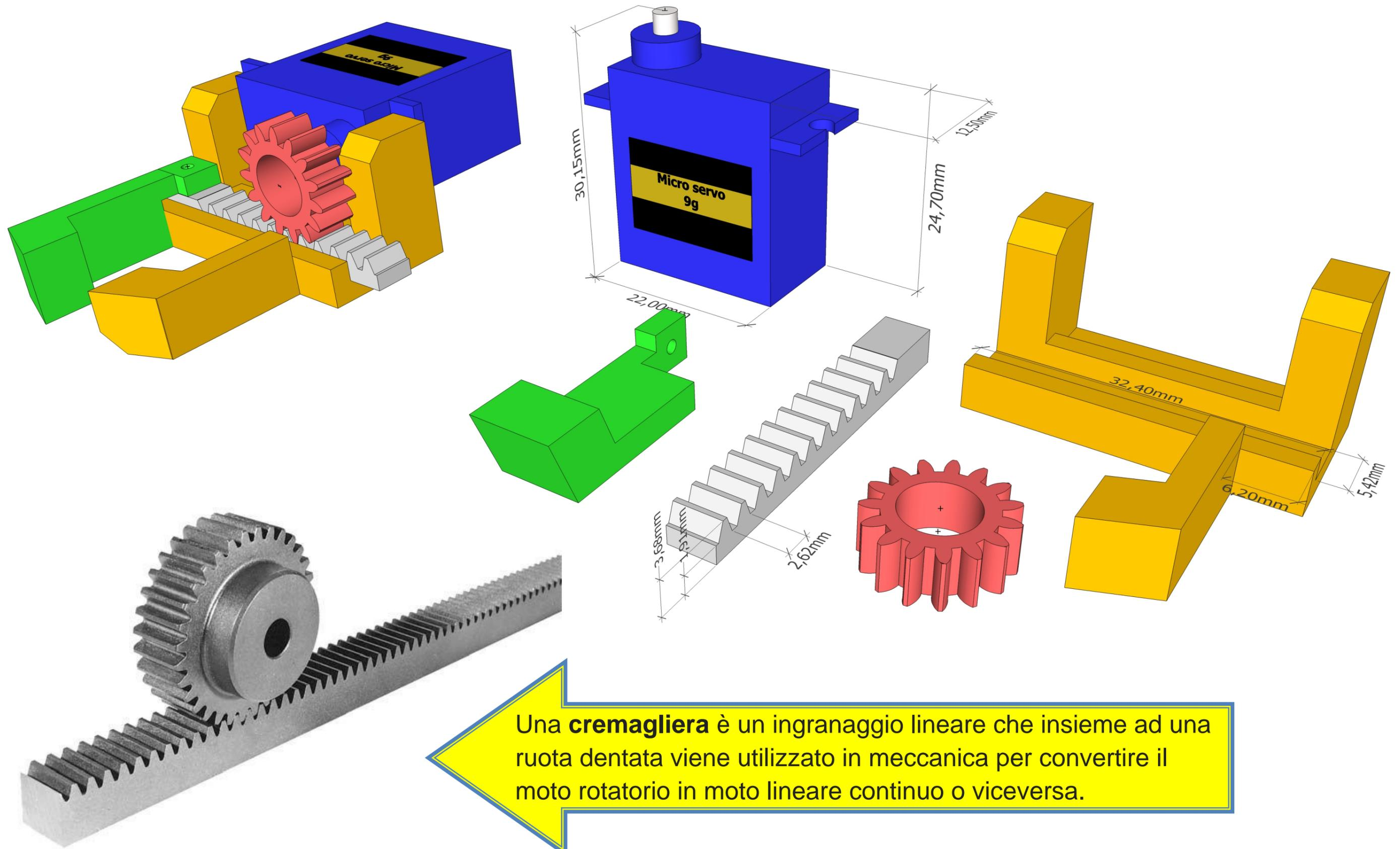
Una **cremagliera** è un ingranaggio lineare che insieme ad una ruota dentata viene utilizzato in meccanica per convertire il moto rotatorio in moto lineare continuo o viceversa.
