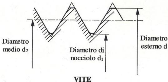
**Diametro medio:** diametro del cilindro primitivo indicato con  $d_2$  per le viti e  $D_2$  per le madreviti.
