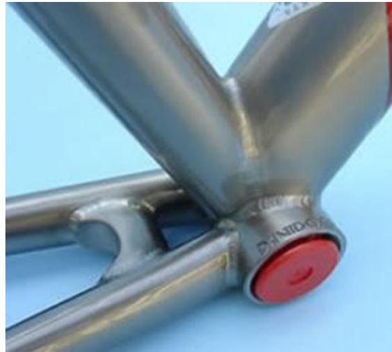
**Collegamenti fissi:** non permettono la separazione dei pezzi accoppiati a meno di non danneggiare o rompere le zone di giunzione.
