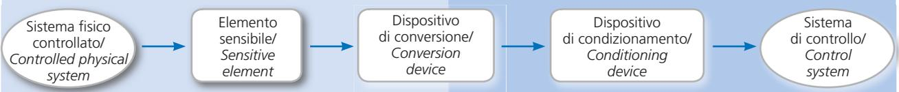
**FIGURA 1** Schema funzionale di un trasduttore./Functional diagram of a transducer.
