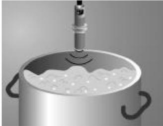
**FIGURA 74** Rilevazione del livello di riempimento (Wenglor).
