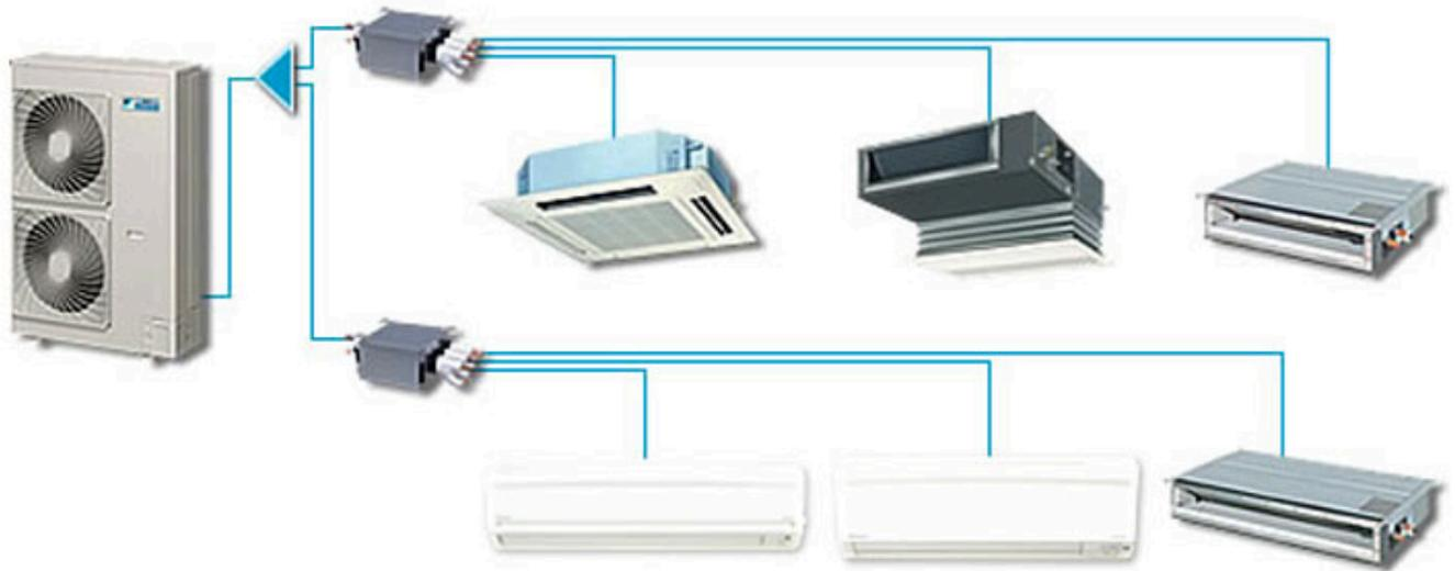
Pertanto tutte le batterie di raffreddamento/riscaldamento sia delle unità interne (split) che dell'U.T.A., saranno alimentate direttamente con il freon proveniente dall'unità esterna dell'impianto di condizionamento.
