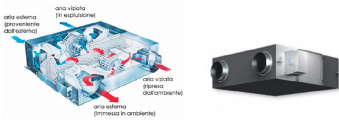
Questi scambiatori consentono di recuperare calore sensibile nella misura del 60-80% e calore latente (umidità) fino al 60-70%. L’aria da immettere nell’ambiente viene in questo modo preriscaldata in inverno e preraffreddata in estate, senza consumo di energia, ma recuperando l’entalpia contenuta nell’aria di espulsione che altrimenti andrebbe persa. Il beneficio energetico è evidente !!!!
