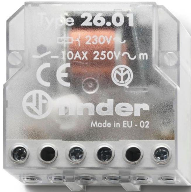
**Relè ad impulsi:** Relè costruiti con caratteristiche tali che il loro funzionamento si ottiene inviando alla bobina impulsi istantanei di corrente. La bobina deve essere alimentata soltanto per il breve periodo di durata dell'impulso.
