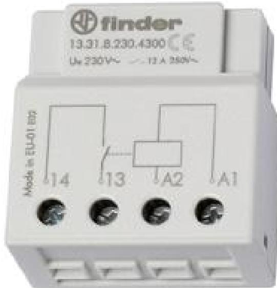
Un relè monostabile è un relè in cui i contatti hanno un solo stato normale di stabilità, ad esempio normalmente aperto, stato da cui escono quando si eccita la bobina. Appena cessa la corrente di eccitazione il contatto torna alla sua posizione di partenza.
