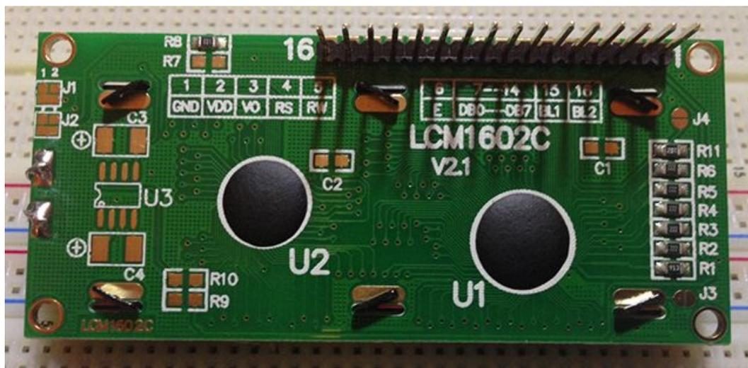
Per poter pilotare il display è indispensabile utilizzare la libreria **LiquidCrystal.h** che permette di comunicare in modalità 4 bit o 8 bit, questo vuol dire che per la trasmissione dati possono essere utilizzate 4 o 8 linee di controllo a queste si aggiungono le due linee di controllo: Register Select (RS) e Enable (E) e alla linea opzionale Read/Write (RW).
