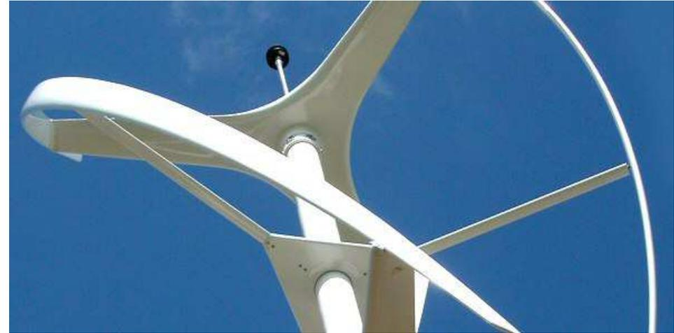
Turbina eolica ad asse verticale con elementi di presa sul vento AUTO-ORIENTABILI
