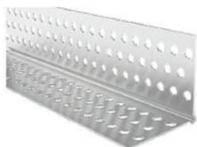
Profilo paraspiangolo per il rinforzo meccanico dell'angolo, in acciaio zincato di prima scelta DX51D+Z. Conforme alle norme UNI EN10326 - EN10327 - EN10142 e realizzati secondo la norma UNI EN14195. Tipologia: DIN 18182.
