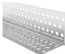
Profilo paraspiangolo con angolo a gradi variabili, per il rinforzo meccanico dell'angolo, in acciaio zincato di prima scelta DX51D+Z. Conforme alle norme UNI EN10326 - EN10327 - EN10142 e realizzati secondo la norma UNI EN14195. Tipologia: DIN 18182.
