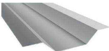
Utile al fissaggio della lastra in cartongesso e consente di mantenere una distanza specifica dal supporto murale, in acciaio zincato di prima scelta DX51D+Z con copertura zinco variabile tra 140/200 gr/m<sup>2</sup>, conforme alle norme UNI EN10326 - EN10327 - EN10142 e realizzato secondo la norma UNI EN14195. Tipologia: DIN 18182.
