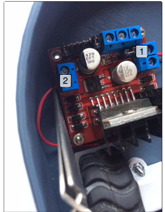
1. Left Motor 2. Right Motor
