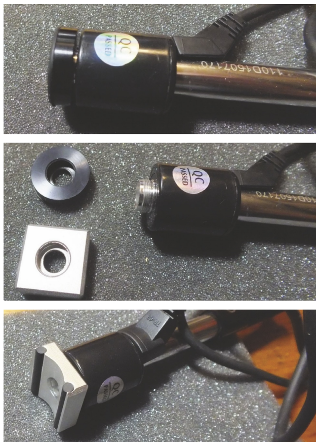
Fig. 6 -7-8 - Procedura di applicazione dell'elemento adattatore sulla testa della sonda, applicazione che avviene sfruttando la filettatura di cui la testa della sonda è dotata. Dopo il montaggio fondamentale verificare che il serraggio sia arrivato a battuta, pena il rischio di trovarsi nuovamente con la distanza tra sonda e superficie da misurare diversa dai 5 mm richiesti.
