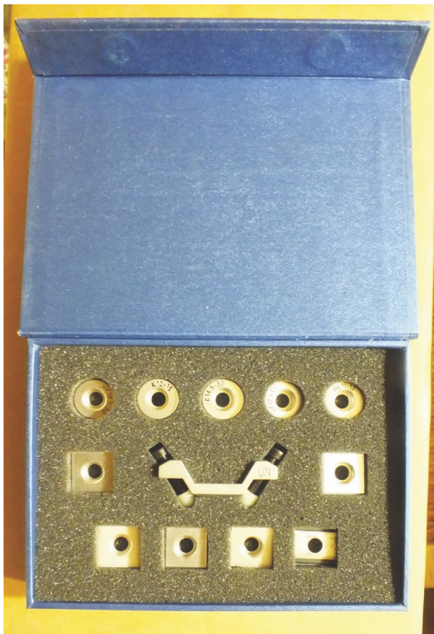
Fig. 3 - Il set di adattatori commercialmente disponibile per permettere di adattare la sonda di Leeb a superfici di diversa curvatura, sia concave sia convesse
