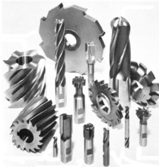
Le frese a profilo costante per fresare, ad esempio gli ingranaggi, sono così denominate perché a seguito dell'affilatura non variano il profilo di taglio. Per ottenere ciò la fresa deve avere il dorso sagomato secondo la spirale di Archimede, e l'affilatura, eseguita sul petto dell'utensile con una mola a tazza, è radiale.
