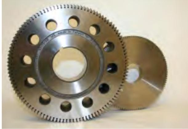
L'utensile ingrana con la ruota ad alta velocità con assi leggermente sghembi per creare lo sfregamento che asporta minuscoli trucioli e la lisciatura del pezzo. L'operazione si fa con abbondante lubrificazione e termina in pochi minuti si esegue prima del trattamento termico.
