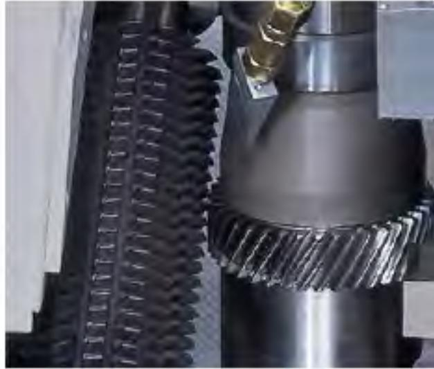
Per dentare le ruote cilindriche a denti elicoidali, l'asse del creatore deve essere inclinato di un angolo pari alla somma delle inclinazioni delle due eliche se la dentatura è sinistra, pari alla differenza fra l'angolo dell'elica della ruota e l'angolo dell'elica del creatore se la dentatura è destra.
