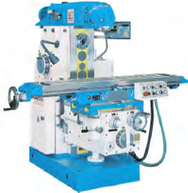
I pezzi possono essere fissati direttamente sulla tavola mediante staffaggio, ma si possono montare sulla tavola morse normali, morse con piattaforma girevole o l'apparecchio divisore.
