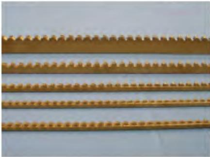
La broccia è un utensile speciale, costruito appositamente per realizzare una lavorazione la cui precisione dipende dall'utensile e non dalla macchina.
