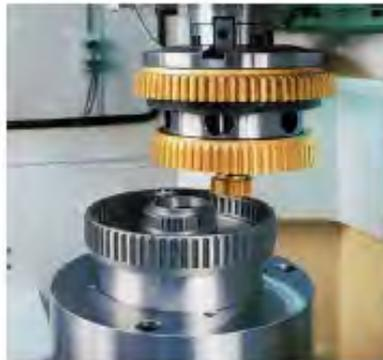
Il moto di lavoro è rettilineo alternativo ed è posseduto dall'utensile. Se l'ingranaggio è elicoidale al moto rettilineo si sovrappone una piccola rotazione che dà luogo ad un moto rettilineo alternato elicoidale.
