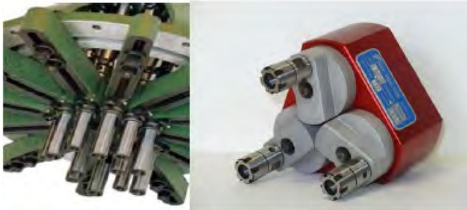
Queste attrezzature consentono di poter operare più fori con una discesa applicandole ad un trapano a colonna ma anche a un trapano radiale.
