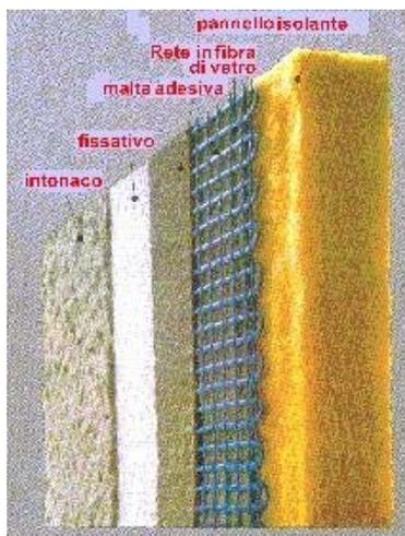
Questo sistema è caratterizzato da un rivestimento isolante situato sulla parte esterna delle pareti d'ambito dell'edificio, così da avvolgerlo completamente. Ciò permette di correggere i ponti termici e di ridurre i dannosi effetti indotti nelle strutture e nei parametri murari dalle variazioni rapide o notevoli della temperatura esterna, migliora il comportamento igrometrico delle pareti (vedi dopo) e aumenta il comfort abitativo.
