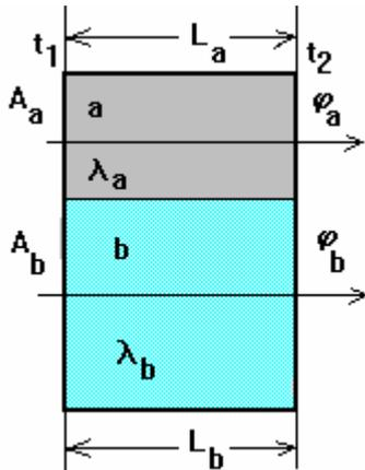
Una disposizione di resistenze termiche è **in parallelo** se agli estremi delle stesse opera la stessa differenza di temperatura.
