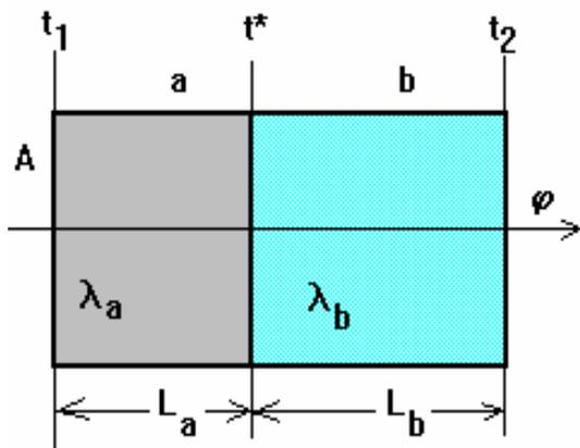
Si consideri, ad esempio, il caso di una parete piana (superficie  $A$ ) composta da due strati  $a$  e  $b$ . Le temperature sulle facce interna ed esterna sono rispettivamente  $t_1$  e  $t_2$ , mentre  $t^*$  è la temperatura al confine dei due strati. In termini di resistenze termiche la situazione è rappresentata nella seguente figura.
