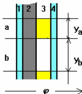
Nel caso di pareti che presentino una struttura più complessa, ad esempio del tipo rappresentato in figura, la trasmittanza termica totale della parete potrà essere sempre ottenuta combinando opportunamente le diverse resistenze termiche in gioco.
