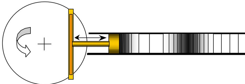
Come rappresentato in figura, la posizione  $x(\tau)$  del pistone è determinata dal collegamento rigido con l'asola rettangolare entro cui si posiziona un piolo fissato sul bordo del disco. In conseguenza il moto del pistone è armonico.
