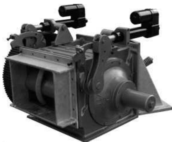
Turbine équipée de deux vannes électrique.
