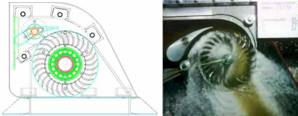
Figure 3.21 – Schéma en coupe de la JLAKit à gauche et visualisation du trajet réel suivi par l'eau dans une turbine Banki à droite.
