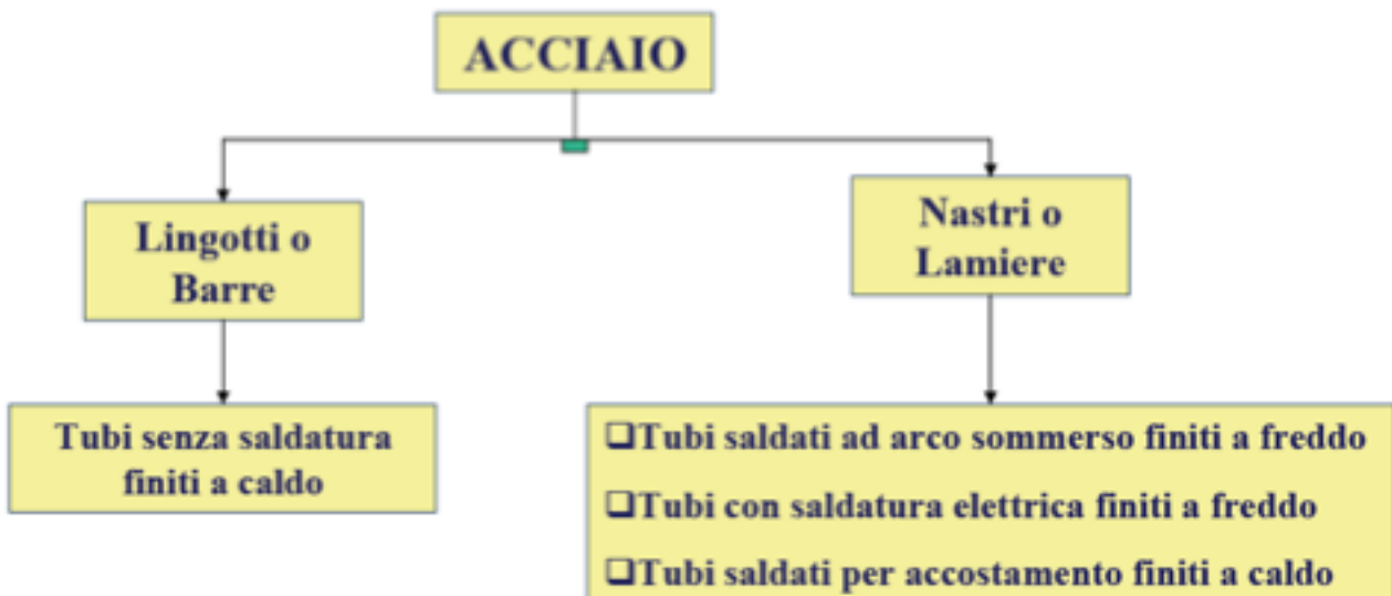
fig. 1.3.1 – Modalità costruttive dei tubi in acciaio.
