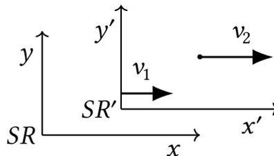
La composizione classica delle velocità prevede che in questo caso le velocità relative si sommino direttamente. Non è così in relatività. Se chiamiamo  $v_1$  la velocità del secondo sistema di riferimento rispetto al primo (la velocità dell'astronave) e  $v_2$  la velocità di un oggetto rispetto a quest'ultimo riferimento (la velocità del missile) allora questo oggetto ha una velocità  $v_T$  rispetto al primo sistema di riferimento (la Terra), secondo questa relazione:
