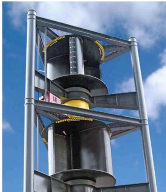
*Figura 3.13 – Macchina di Savonius*
