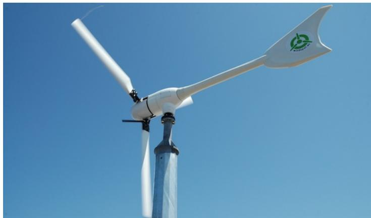
*Figura 3.12 – Turbina eolica con timone direzionale*
