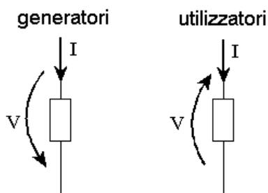
In un bipolo generatore la tensione e la corrente hanno lo stesso verso. In un bipolo utilizzatore la tensione e la corrente hanno verso opposto.
