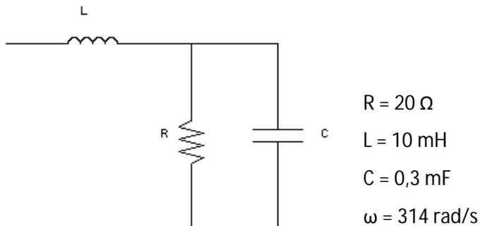
Si trasforma il circuito in un circuito di impedenze.
