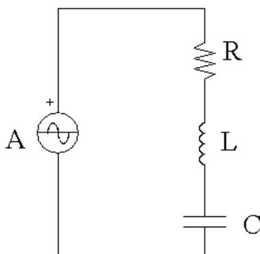
Il circuito è in condizione di risonanza quando l'energia rilasciata da uno degli elementi è completamente assorbita dall'altro e viceversa. Questo avviene quando le due reattanze,  $X_C$  e  $X_L$  sono uguali. Poiché le impedenze hanno segno diverso:
