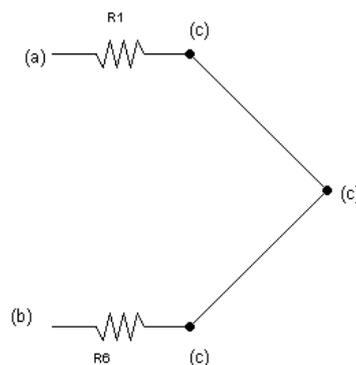
Si cercano le resistenze che hanno in comune un morsetto (resistenze in serie) o due morsetti (resistenze in parallelo). Le resistenze  $R_1$  e  $R_6$  sono in serie perché hanno in comune il morsetto (c):
