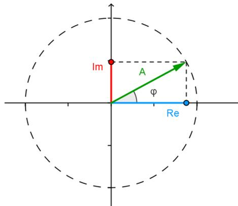
Man mano che il vettore ruota, il **SENO DELL'ANGOLO  $\varphi$**  assume tutti i valori compresi tra  $-A$  e  $A$ . Questo valore è chiamato **AMPIEZZA** della sinusoide.
