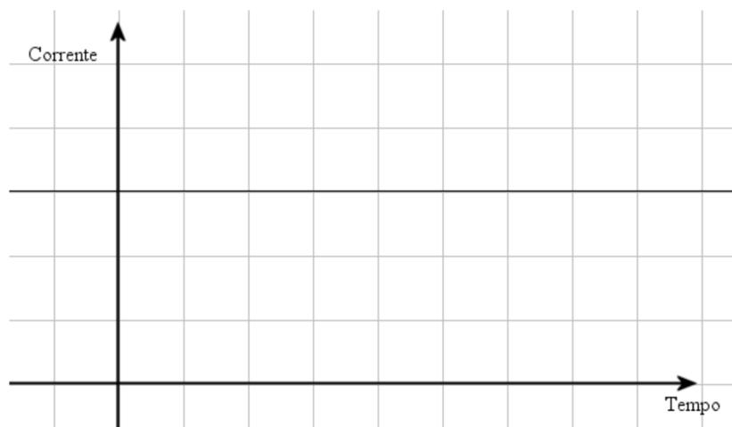
**LA CORRENTE CONTINUA È QUINDI UNA CORRENTE COSTANTE, CHE NON VARIA MAI AL PASSARE DEL TEMPO.** Molti apparecchi elettrici funzionano in corrente continua: tutti quelli alimentati da batterie funzionano in corrente continua, così come tutte le apparecchiature elettroniche che necessitano di un trasformatore per funzionare.
