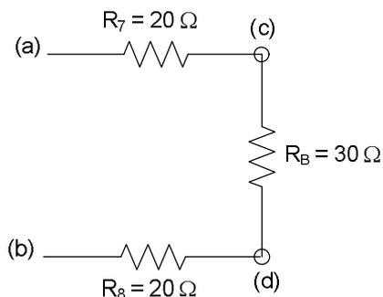
Le resistenze  $R_7$ ,  $R_B$  e  $R_8$  sono in serie perché stanno sullo stesso ramo:
