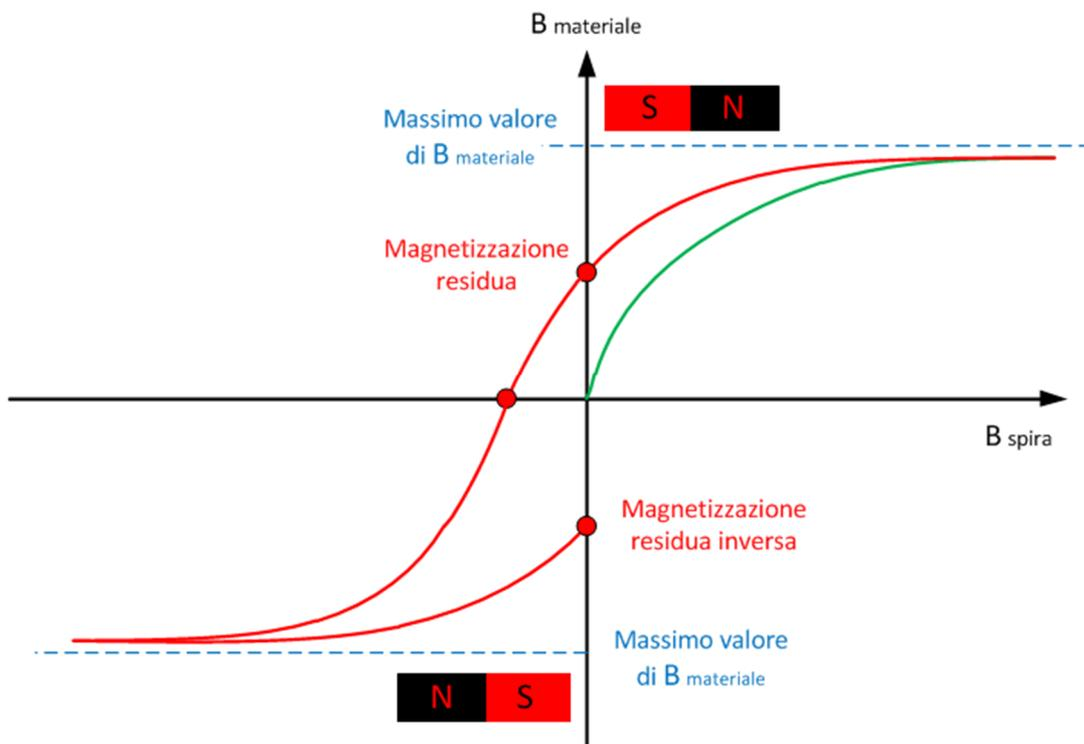
Se ora cambiamo nuovamente il verso della batteria vediamo che il materiale si smagnetizza progressivamente e quando il suo campo magnetico è nullo nella spira sta comunque scorrendo corrente. Se proseguiamo aumentando la corrente il ciclo si chiude e non ritorna più al punto di partenza: la linea verde viene quindi percorsa solo al primo ciclo e nei successivi si percorre la linea rossa:
