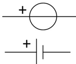
I generatori di tensione si caratterizzano per la tensione che erogano, che si indica con la lettera  $E$  ed è misurata in **VOLT**.
