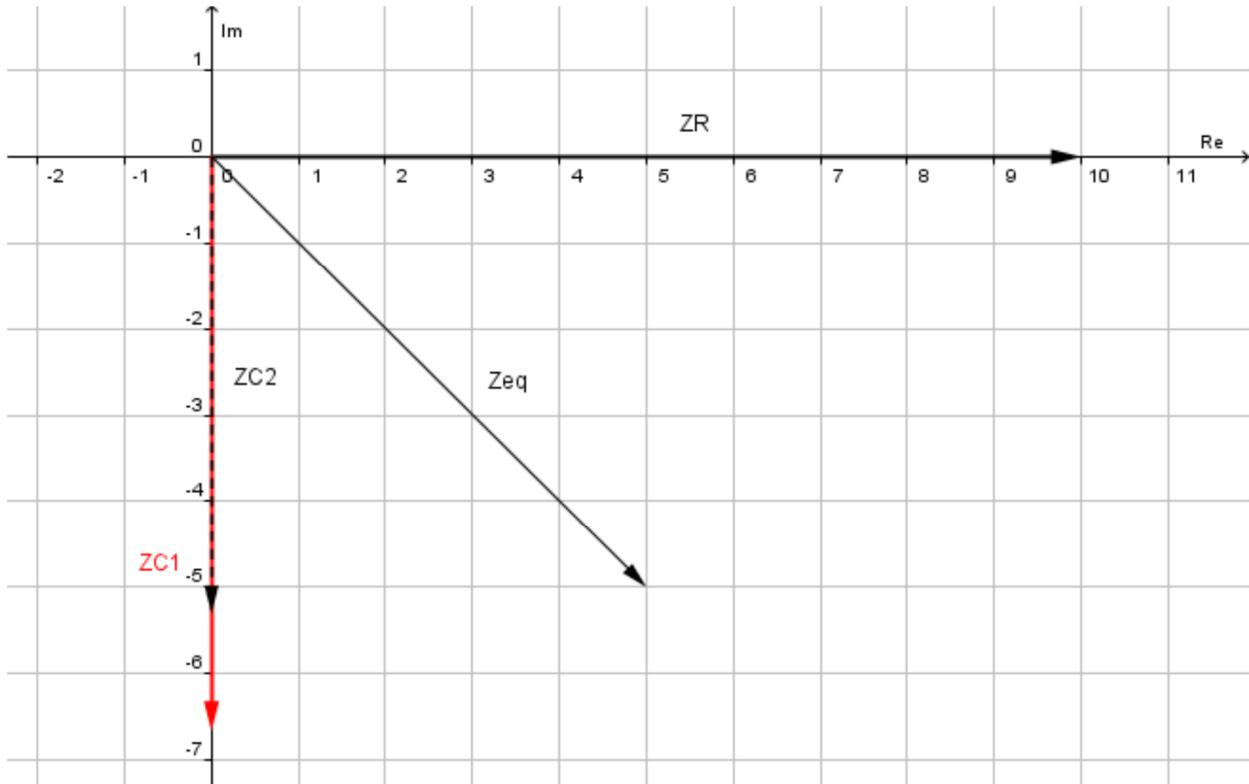
**CIRCUITO 2:** dato il circuito seguente calcolare l'impedenza equivalente e rappresentare tutte le impedenze sul piano complesso.
