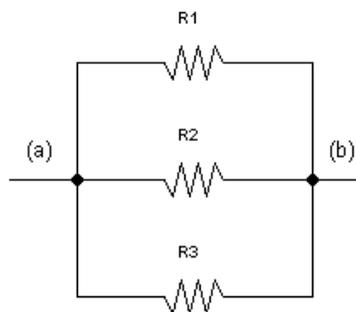
A questo punto possiamo calcolare il parallelo delle tre resistenze e quindi la resistenza equivalente:
