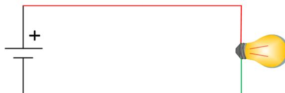
La corrente scorre nel **primo filo**, arriva alla lampadina (che è in pratica una resistenza che dissipa energia producendo luce per effetto Joule) e poi torna indietro lungo il **secondo filo**.
