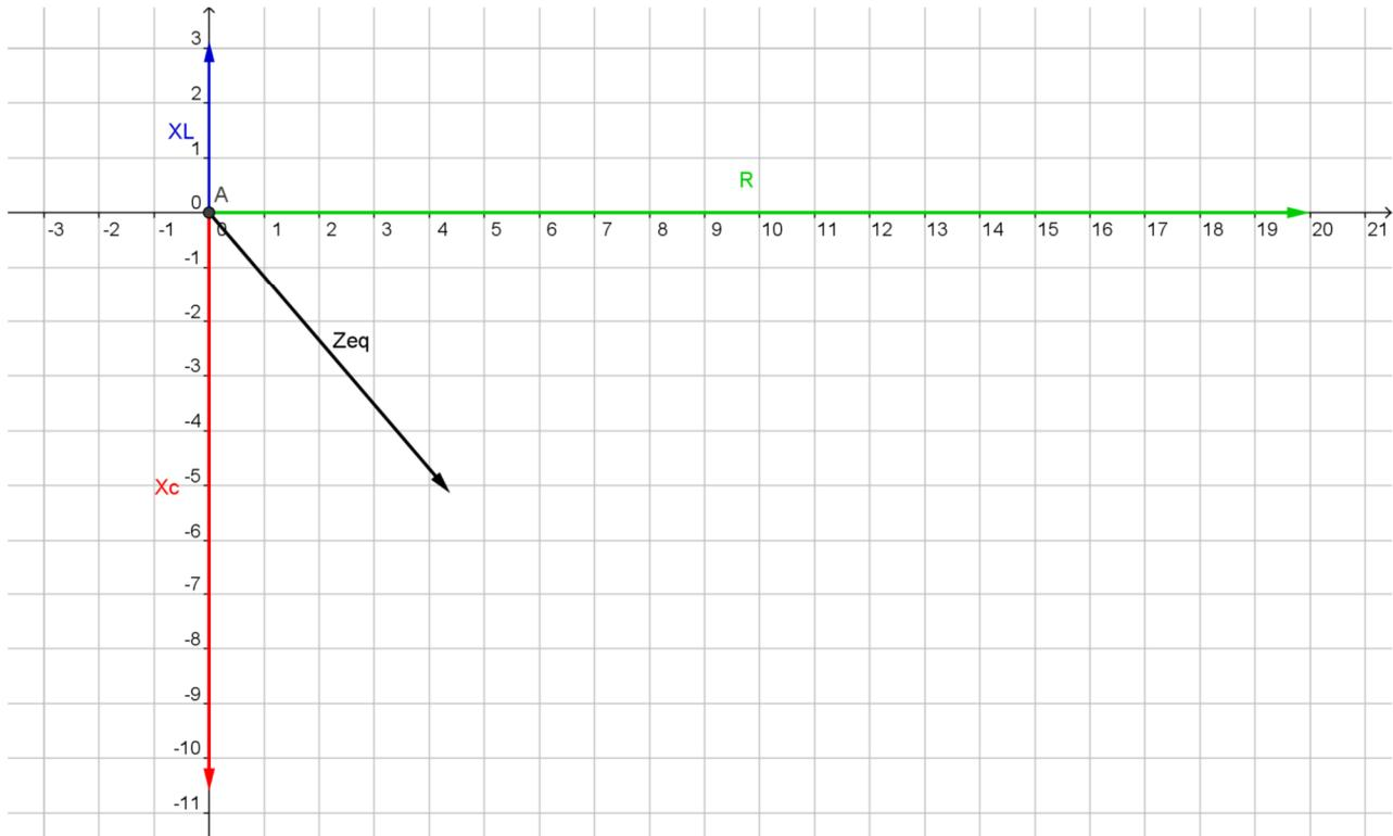
**CIRCUITO 3:** calcolare la corrente che scorre nel circuito e il valore delle tensioni ai capi dei tre utilizzatori. Rappresentare poi sul piano di Gauss le tre impedenze, la tensione e la corrente
