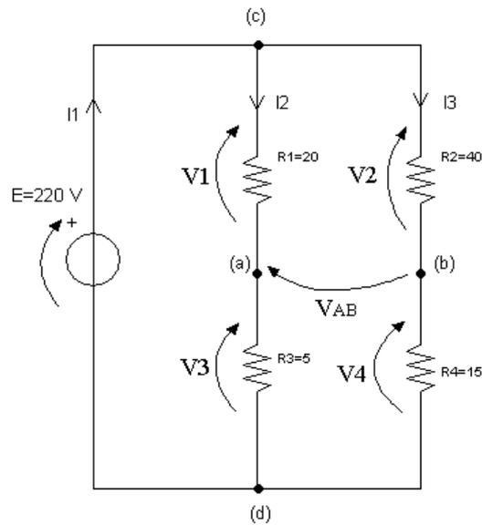
$$V_{AB} + V_1 - V_2 = 0$$
