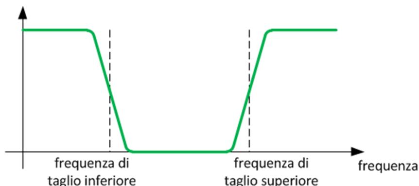
Nel caso dei filtri passa banda ed elimina banda le due frequenze di taglio si chiamano frequenza di taglio superiore e frequenza di taglio inferiore.
