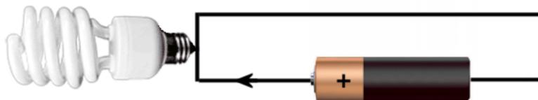
Schematizzando e adottando alcune semplificazioni, le apparecchiature elettriche sono costituite da un circuito elettrico composto da un bipolo generatore (che produce energia sotto forma di corrente elettrica o di tensione) e un bipolo utilizzatore (che utilizza questa energia). Il bipolo utilizzatore è una resistenza, cioè un pezzo di metallo che si oppone al passaggio della corrente e si riscalda per effetto Joule.
