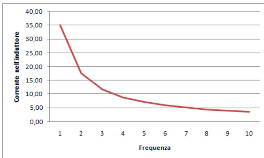
Per valori molto bassi di frequenza (corrente quasi continua), la corrente che scorre nell'induttore è elevatissima. Quando la frequenza è nulla la corrente nell'induttore diventi infinita e quindi l'induttore si comporta come un cortocircuito.
