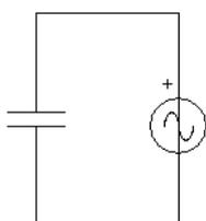
Ora immaginiamo di cambiare la frequenza della tensione di alimentazione, mantenendo costante il valore efficace, cioè considerando che la tensione sia sempre  $E = 100 \text{ V}$ .
