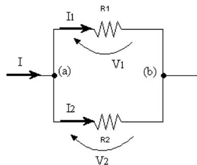
La corrente  $I$ , giunta al nodo (a) si divide nei due rami, nelle componenti  $I_1$  e  $I_2$ .
