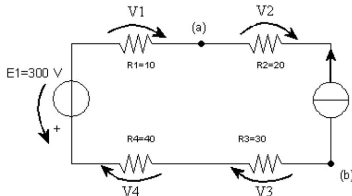
Consideriamo una maglia in cui sono presenti un certo numero di bipoli, generatori e utilizzatori: ai capi di ognuno di essi c'è una differenza di potenziale che va in un verso o nell'altro a seconda del tipo di bipolo (generatore o utilizzatore).
