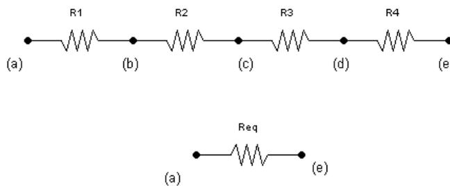
Le resistenze  $R_1$  e  $R_2$  hanno in comune il morsetto (b), le resistenze  $R_2$  e  $R_3$  hanno in comune il morsetto (c), ecc...
