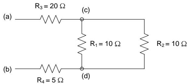
Si osservano le varie resistenze e si individuano (se ce ne sono) quelle che hanno lo stesso morsetto ai due capi, cioè che sono cortocircuitate. Se ci sono, le si elimina dal circuito. In questo esempio non ci sono resistenze cortocircuitate.
