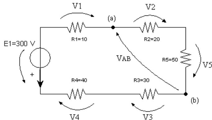
La corrente nel circuito si può calcolare tramite l'equazione che risulta dall'applicazione della legge di Kirchoff alla maglia:
