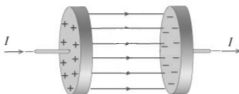
Le cariche elettriche arrivano al condensatore e rimangono "intrappolate" al suo interno. Quando il condensatore è pieno le cariche sono costrette a fermarsi. Se si sta usando corrente continua il condensatore, una volta pieno, può essere visto come un circuito aperto. Se però si sta utilizzando corrente alternata, ad un certo punto gli elettroni cominciano a scorrere nella direzione opposta (la corrente inverte la sua polarità). Siamo cioè nella parte negativa del diagramma:
