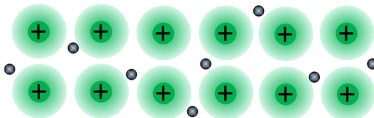
I materiali metallici sono ottimi conduttori; ad esempio il rame viene utilizzato come conduttore in ogni circuito e lo stagno è usato per fare le saldature.
