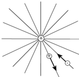
La corrente elettrica non è altro che un movimento ordinato di cariche all'interno di un percorso, ad esempio all'interno di un filo di rame.
