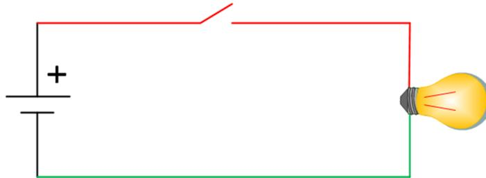
Quando l'interruttore è chiuso la batteria fornisce corrente alla lampadina; siamo nel caso del circuito precedente.
