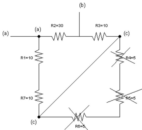
Le resistenze  $R_4$ ,  $R_5$  ed  $R_6$  sono cortocircuitate e quindi si possono togliere dal circuito.
