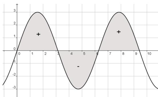
Questo significa che il condensatore, che non lasciava più passare la corrente in un verso, ora si trova nella condizione migliore per condurre la corrente. Quindi il condensatore, in corrente alternata, facilita il passaggio della corrente. In corrente continua, invece, una volta che il condensatore è saturo la corrente è costretta a fermarsi e il condensatore non ha modo di scaricarsi. Si comporta quindi come un circuito aperto.
