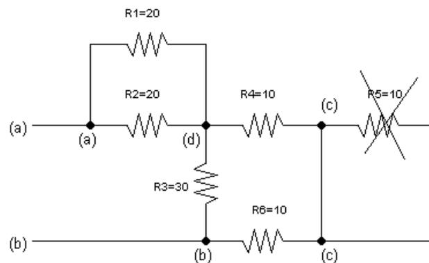
La resistenza  $R_5$  sparisce perché è cortocircuitata.
