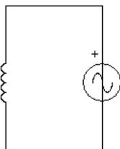
Ora immaginiamo di cambiare la frequenza della tensione di alimentazione, mantenendo costante il valore efficace, cioè considerando che la tensione sia sempre  $E = 220 \text{ V}$ .
