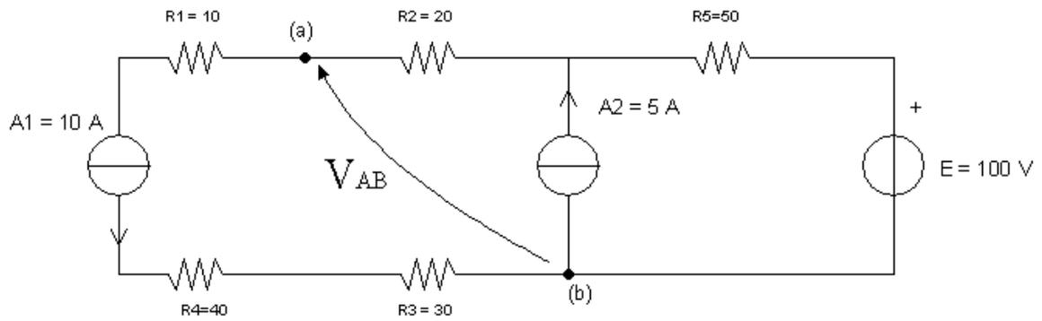
**ESERCIZIO 4:** calcolare le correnti che scorrono nei tre rami del circuito [ $I_1 = -5 \text{ A}$ ;  $I_2 = 15 \text{ A}$ ].
