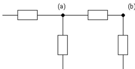
Nella figura è mostrato un tratto di circuito con due morsetti: nel caso del morsetto (a) siamo di fronte ad un nodo, mentre nel caso del morsetto (b) siamo di fronte ad un morsetto.
