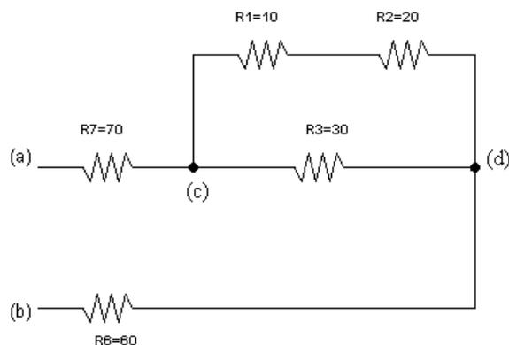
Si cercano le resistenze che hanno in comune un morsetto (resistenze in serie) o due morsetti (resistenze in parallelo).
