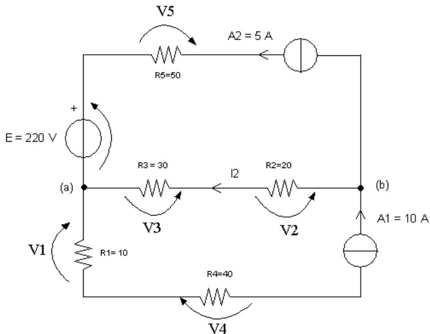
Poiché abbiamo una sola corrente incognita, è sufficiente scrivere l'equazione di Kirchoff ad uno dei due nodi. Scegliamo, ad esempio, il nodo (a):
