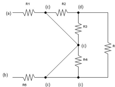
Le resistenze  $R_2$ ,  $R_3$ ,  $R_4$  ed  $R_5$  sono cortocircuitate e quindi possono essere eliminate dal circuito.
