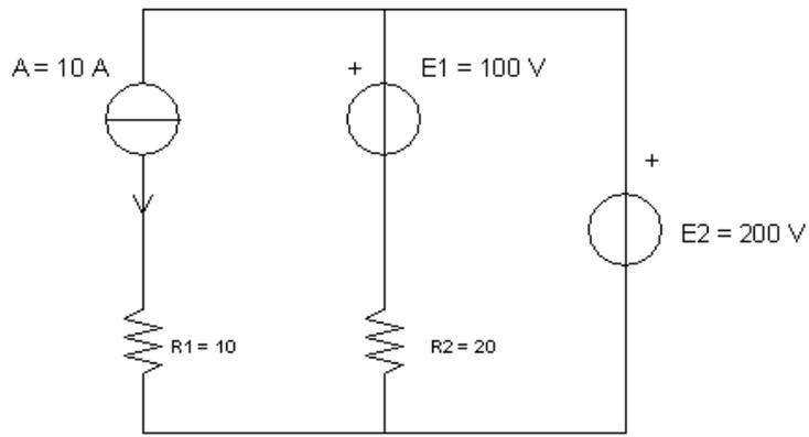
**ESERCIZIO 5:** calcolare le correnti che scorrono nei tre rami del circuito [ $I_1 = 4 \text{ A}$ ;  $I_2 = 6 \text{ A}$ ].
