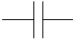
Il condensatore si indica di solito con la lettera  $C$ ; ad esso è attribuita una capacità che si misura in **FARAD [F]**. Il Farad è un'unità di misura molto grande e quindi, solitamente, i condensatori hanno capacità dell'ordine del microfarad [ $\mu F$ ].
