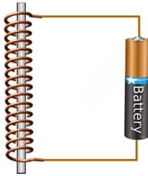
A contatto con il campo magnetico esterno, che indichiamo  $B_{spira}$  il metallo si magnetizza acquistando un campo magnetico, che chiamiamo  $B_{materiale}$ .
