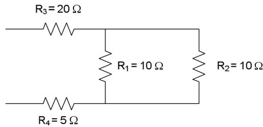
Ci proponiamo di calcolare la resistenza equivalente ai morsetti (a) e (b) di questo circuito.
