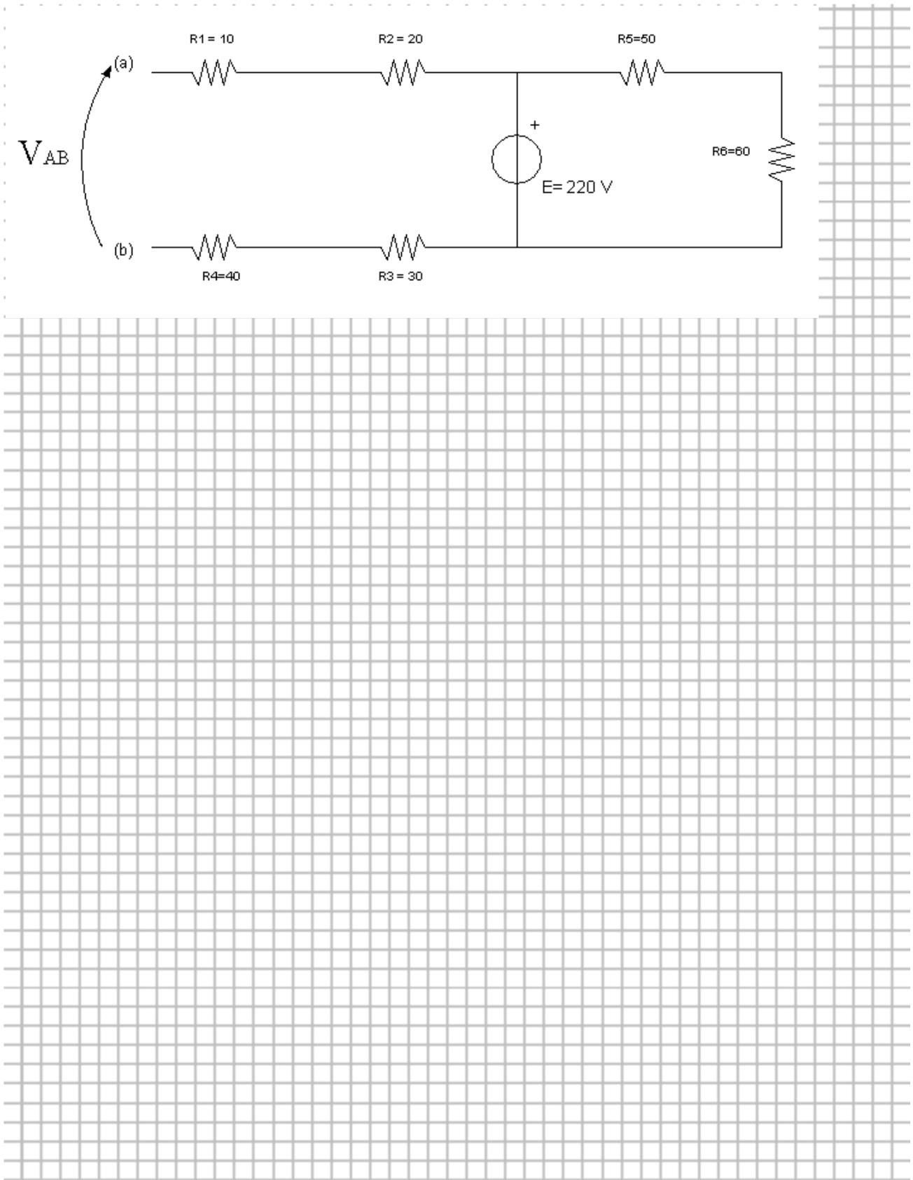
**ESERCIZIO 3:** calcolare la corrente che scorre nella resistenza R5 utilizzando la legge di Kirchoff ai nodi e calcolare la tensione VAB [VAB = - 350 V]
