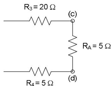
Le tre resistenze  $R_3$ ,  $R_4$  ed  $R_A$  sono in serie perché stanno sullo stesso ramo. La resistenza equivalente ai morsetti (a) e (b) sarà allora:
