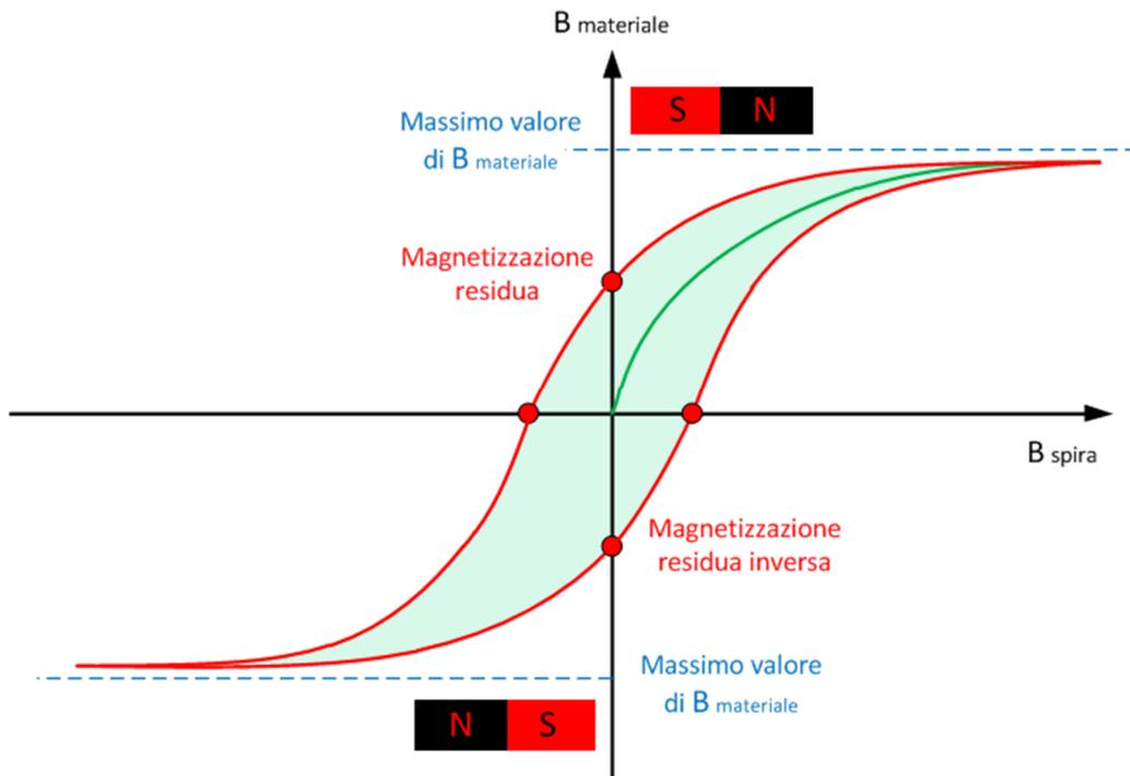
Questo è dunque il modo in cui vengono creati i magneti permanenti. Questo tipo di magneti trova largo impiego in moltissime apparecchiature. Ad esempio, all'interno degli hard disk sono contenuti due potenti magneti:
