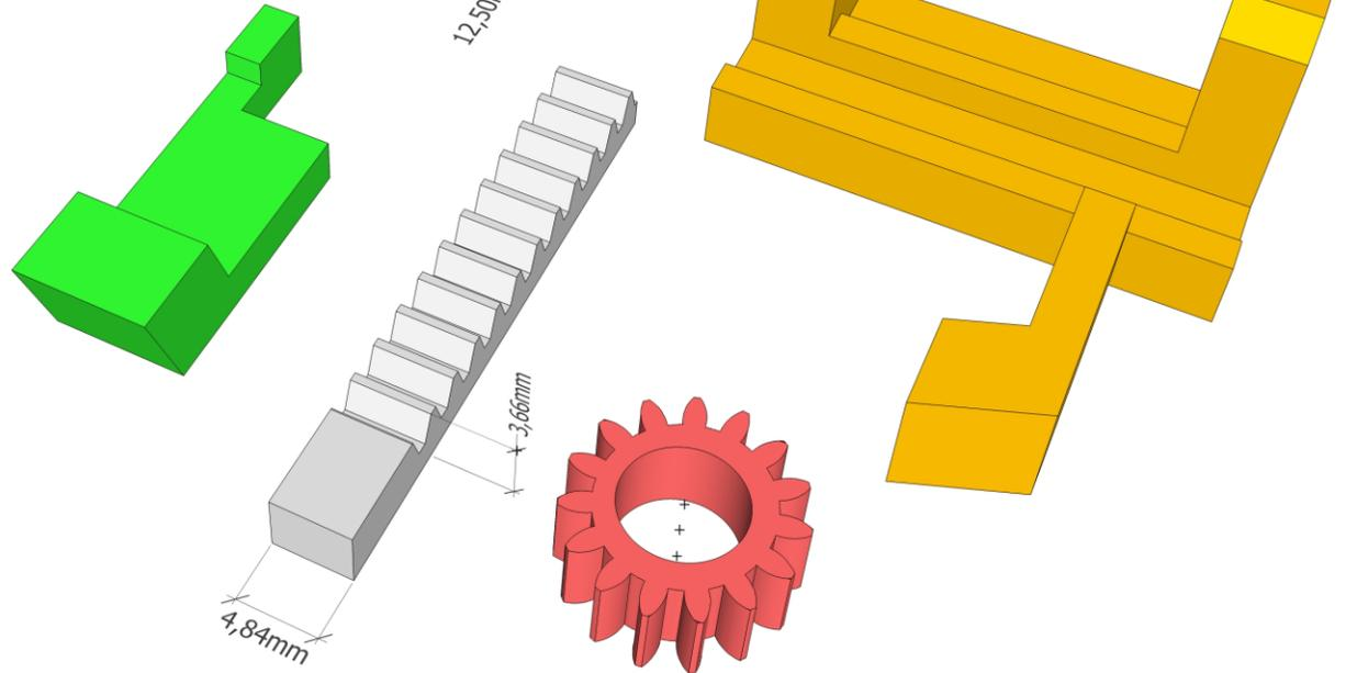
Una cremagliera è un ingranaggio lineare che insieme ad una ruota dentata viene utilizzato in meccanica per convertire il moto rotatorio in moto lineare continuo o viceversa.
