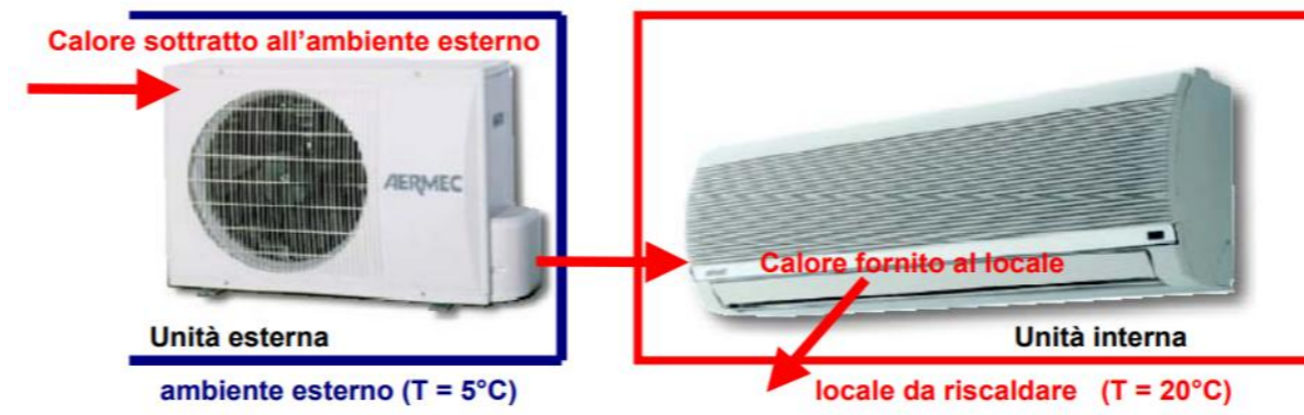
Climatizzazione invernale (riscaldamento).
