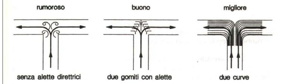
Fig. 13.15 Linee guida per ridurre il rumore rigenerato dai Te.
