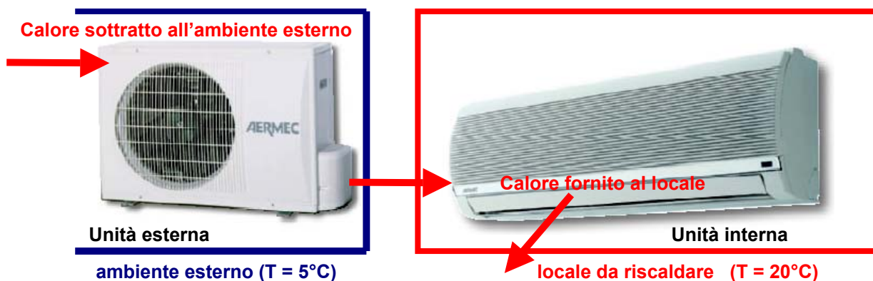
Climatizzazione invernale (riscaldamento).
