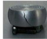
I difetti tipici nelle operazioni di forgiatura sono la formazione di fratture, che possono essere duttili, segnate da bordi più irregolari o causate da instabilità plastica. Queste fratture sono sempre inclinate di 45° rispetto al piano di appoggio, questo perché è la direzione di sforzo massimo.
