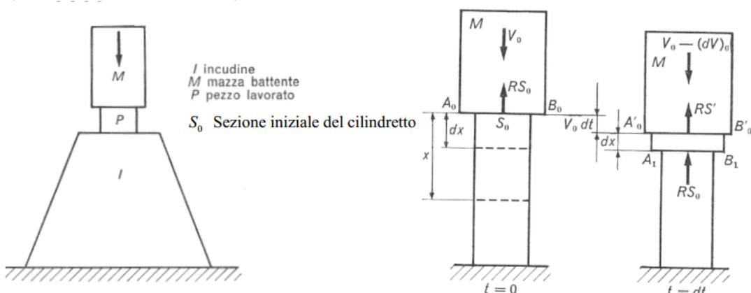
Negli istanti successivi la deformazione si espande al resto del provino, che quindi si deforma, ma
