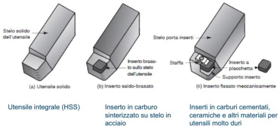
A seconda del tipo di lavorazione inoltre, dobbiamo scegliere gli inserti di forma adeguata, ad esempio è preferibile usare inserti tondi per il titanio o inserti con angoli piccoli ( $35^\circ$ ) per poter creare geometrie strette interne al pezzo. Tuttavia la geometria del tagliente influenza anche la sua resistenza meccanica.
