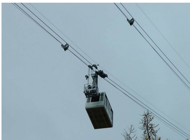
Figura 14 – Avvicinamento del carrello di soccorso alla vettura
