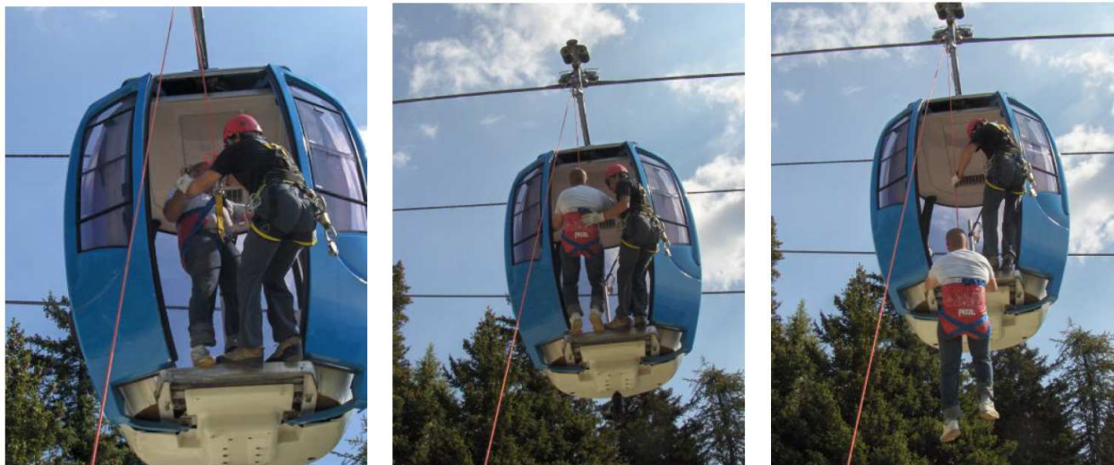
Figura 10 – Calata del passeggero: posizionamento triangolo di evacuazione (sinistra), accompagnamento verso le porte di uscita (centro) e calata a terra (destra).
