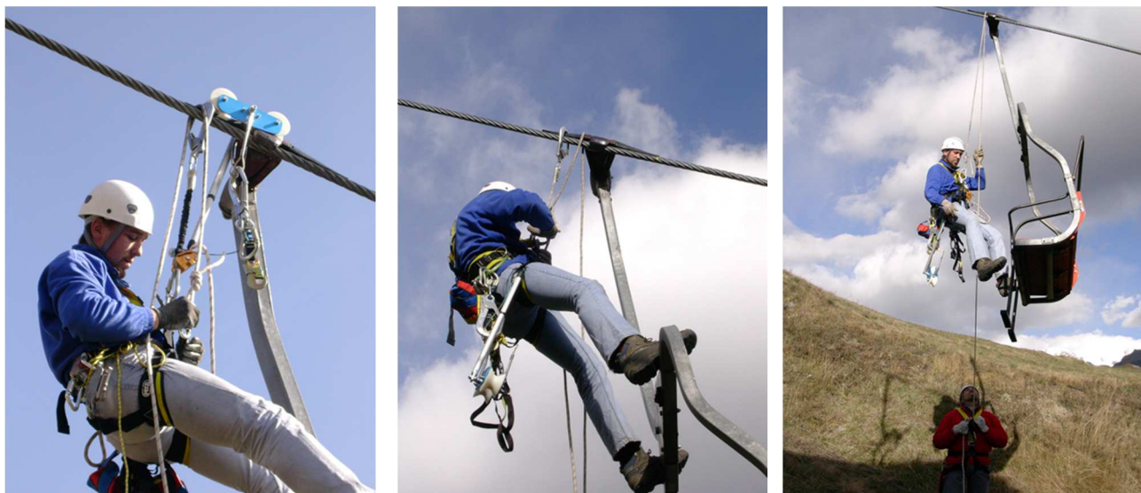
Figura 8 – Discesa del soccorritore aereo al termine della campata
