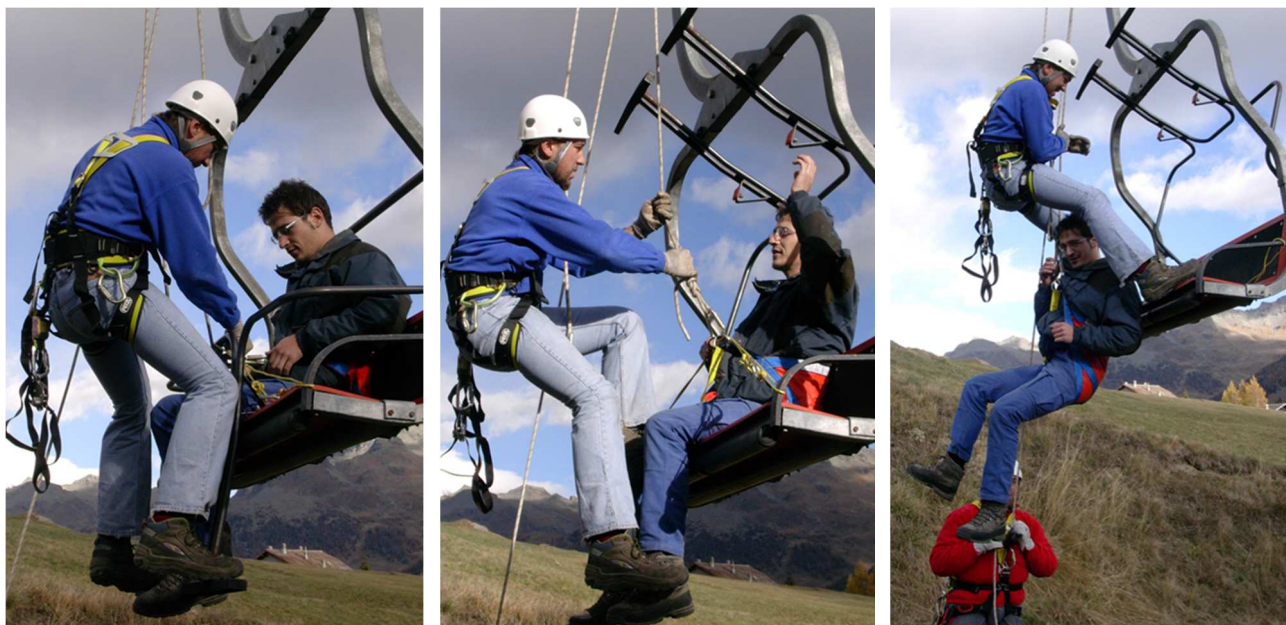
Figura 6 – Evacuazione dei passeggeri: fissaggio del triangolo di evacuazione (a sinistra), sollevamento della barra poggiapiedi (al centro) e discesa del passeggero (a destra)
