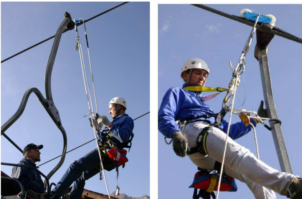
Figura 5 – Calata sul veicolo: con longe regolabile tramite grillon (a sinistra) e con longe corta fissata attorno alla sospensione (a destra)
