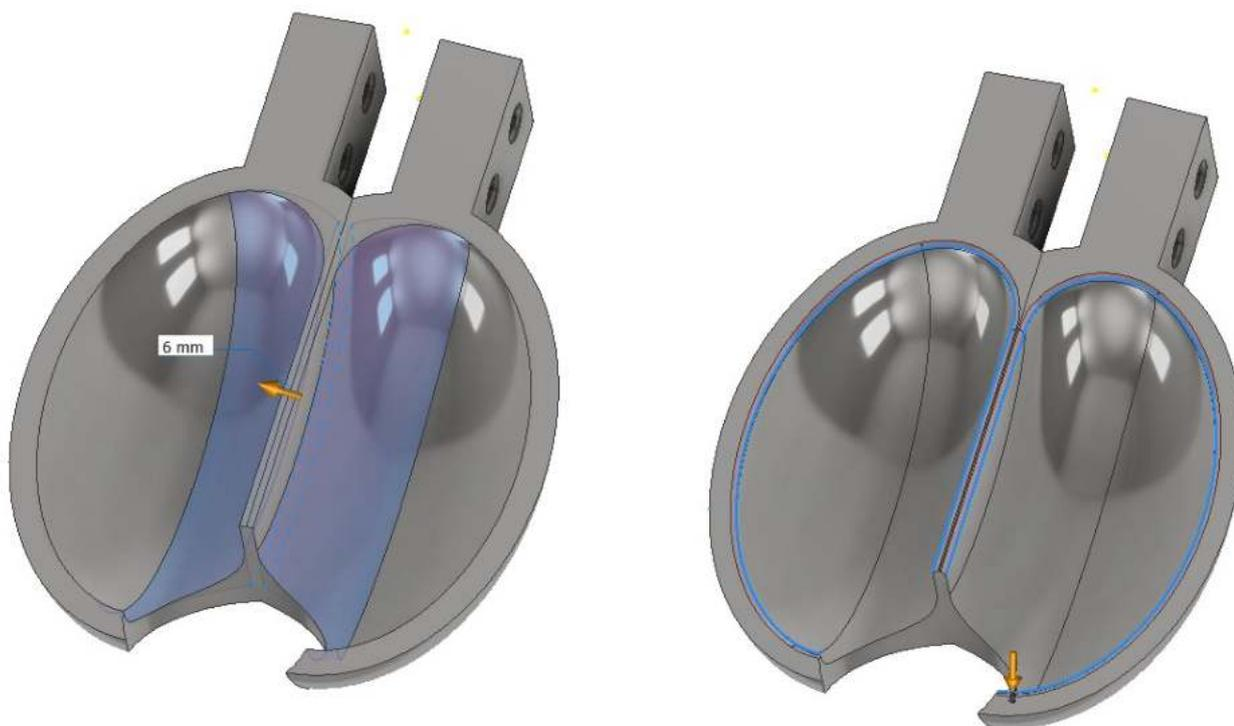
Procedere con lo schizzo come in figura per ricavare l'angolo di uscita del fluido dai bordi della pala
