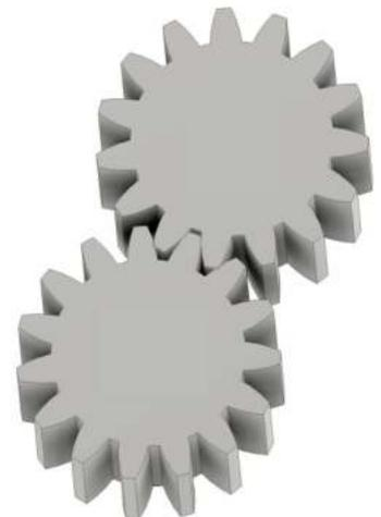
Procedere creando un **foro** passante da 16mm sulla ruota superiore e **foro** passante da 18mm sulla ruota inferiore
